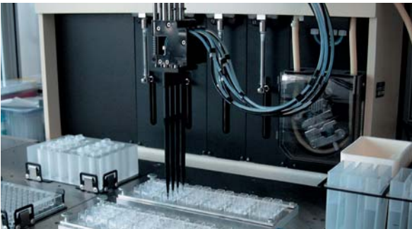
Hochdurchsatz-Roboter für Zellkulturarbeiten
